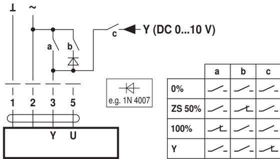
Zwangssteuerung mit AC 24 V mit Drehschalter
