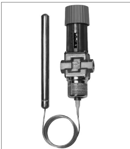
Die AVTA-Thermogesteuerter Kühlwasserregler werden weithin zur Temperaturregelung in unterschiedlichsten Maschinen und Installationen mit Kühlbedarf eingesetzt. AVTA-Kühlwasserventile öffnen sich stets, um bei steigender Fühlertemperatur den Durchfluss zu ermöglichen.
